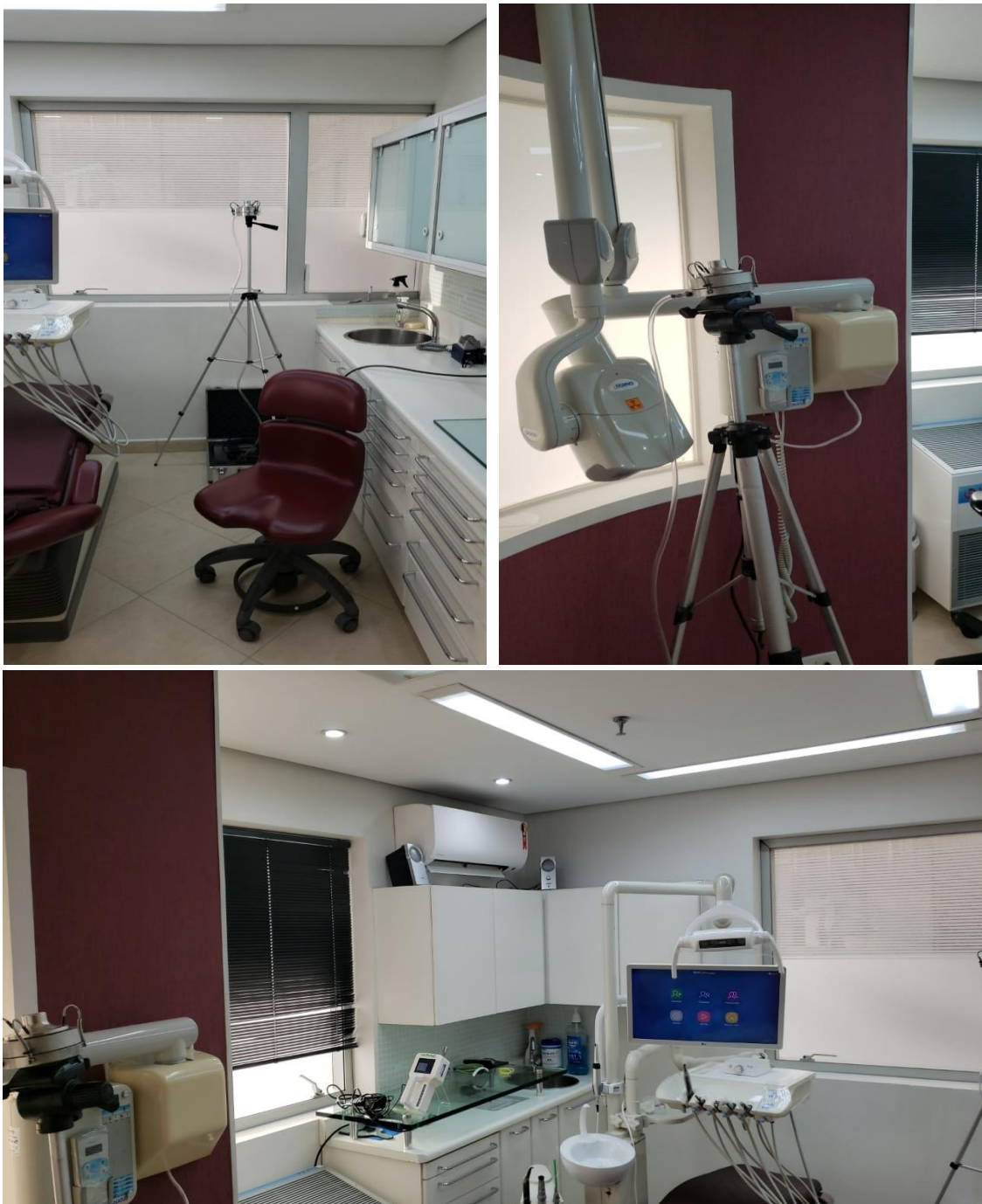
Figura 3: Disposição dos equipamentos de amostragem de bactérias no ar.
